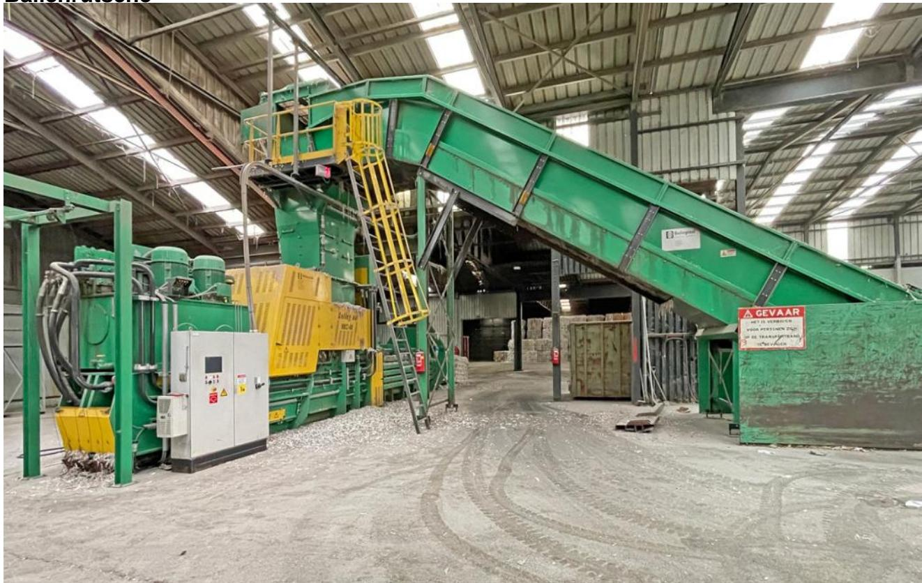
Es handelt sich um eine komplette Ballenpressen Linie, bestehend aus der Ballenpresse, einem Kettengurtförderband, Wartungspodest, Aufstiegsleiter, Drahtzugstationen (ohne Draht), und einer Ballenrutsche.
