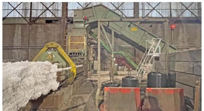
**Ballenpresse Bollegraaf, Typ HBC 60 A, 60 t Presskraft, Baujahr 2000, 32.169 Betriebsstunden, Antrieb 45 kW, mit Förderband und Drahtstationen**
