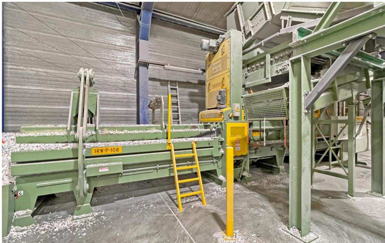
Diese Maschine hat im Gegensatz zu den normalen HBC Pressen Serien von Bollegraaf keine Vorpressklappe sondern schneidet das Material zwischen Messern auf der Pressramme und dem Gegenmesser im Rahmen ab. Es ist damit eine Schneidkanten Presse wie zum Beispiel eine Paal, unoTech etc. Die Presse ist in einem sehr guten Zustand für ihr Alter, da sie ausschließlich zum Verpressen von Papier aus der Aktenvernichtung genutzt wurde.
