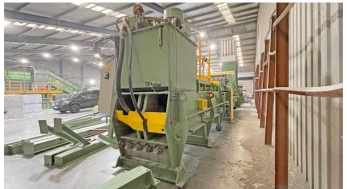
**Ballenpresse Bollegraaf, Typ HBK 100, Presskraft 100 t , Baujahr 2004, nur 34.480 Betriebsstunden, Antriebsleistung 45 kW, mit 5-fach Vertikalabbindung**
