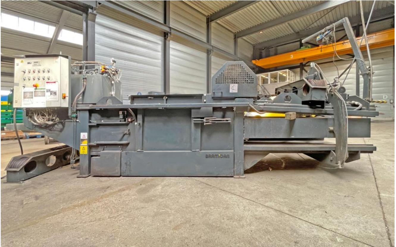
Die Bramidan HC 50 entspricht dem original Hersteller Presto, Typ HPK 50. Die Presse wurde in unserer Werkstatt teilüberholt und abschließend getestet.
