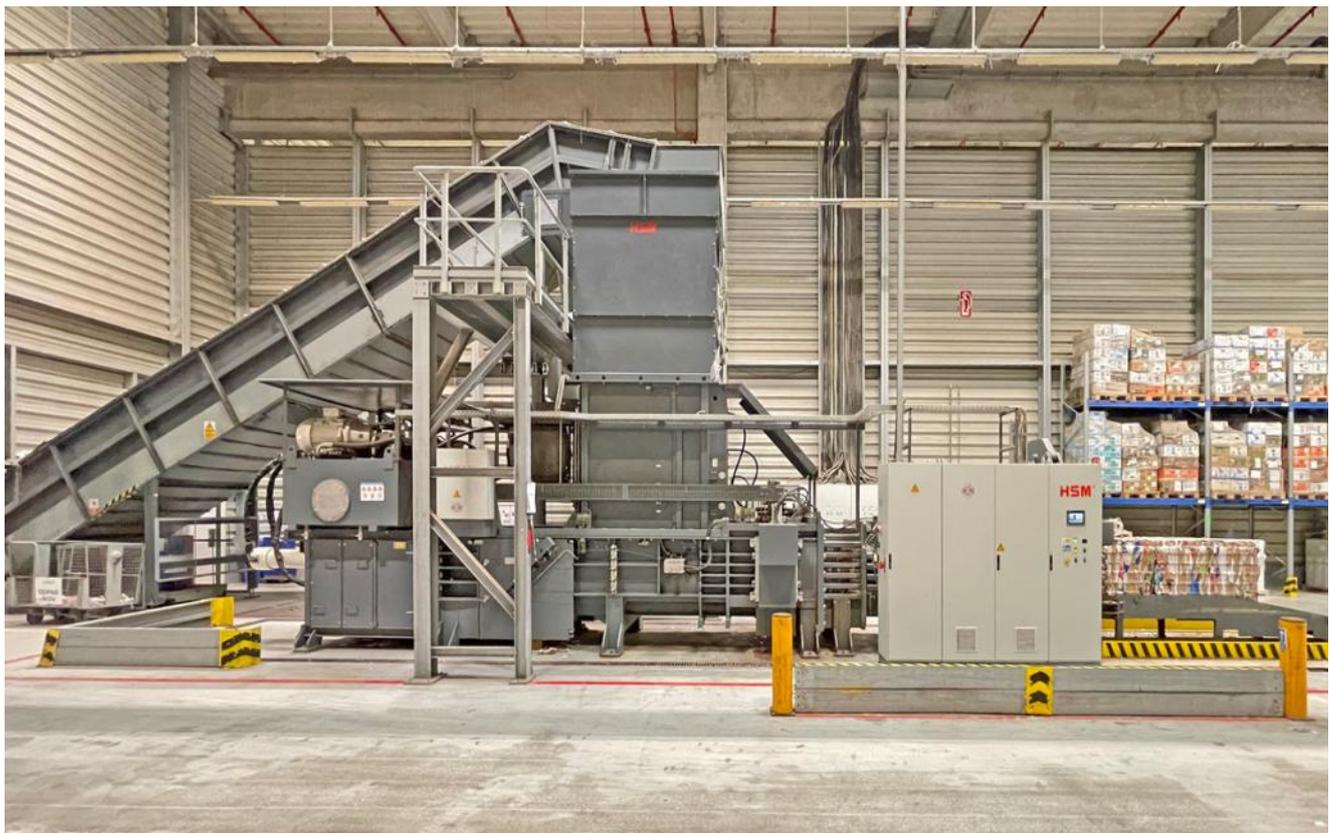
Die gesamte Pressanlage (Ballenpresse und Fördertechnik) sind in einem guten, einsatzbereiten Zustand, und werden vom Betreiber wöchentlich gereinigt, nach Herstellermaßgabe abgeschmiert und gewartet. Zum Verkauf steht das Aufgabeförderband, das quer verlaufende Verteilerband und die Ballenpresse, mit Ballenrutsche aber ohne Drahtzugstationen und ohne Draht.
