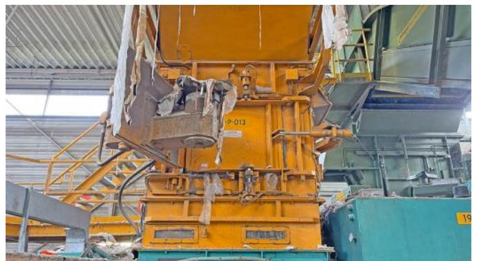
**Ballenpresse MACPRESSE, Typ 112, 200 t Presskraft, Baujahr 2002, 43.459 Betriebsstunden, Antrieb 2 x 75 kW, Grossformat, mit 5-fach Horizontalabbindung**
