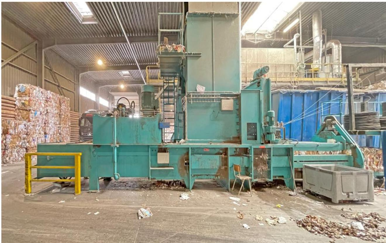
Die Presse und das Förderband sind in einem befriedigenden gebrauchsfähigen Zustand, siehe Fotodokumentation. Weitere technische Daten und Maße zum Förderband sind zurzeit nicht bekannt. Die Anlage ist aktuell noch in Betrieb und soll in den nächsten Monaten gegen eine größere Pressanlage ausgetauscht werden.
