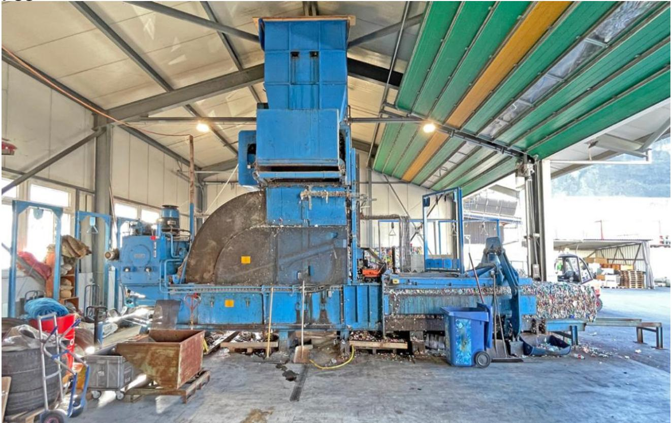
Es handelt sich um eine Komplettanlage, bestehend aus der Ballenpresse BOA 2040, dem BOA Kettengurtförderband BOA 1500 HS 29° KTH 3000 \*13625 \* 1500, den PET-Flaschen Plätter BOREMA L-1600, dem berührungslosen Personen Schutzsystem BOREMA ibor 12, Drahtzugstationen (ohne Draht) und Ballenrutsche.
