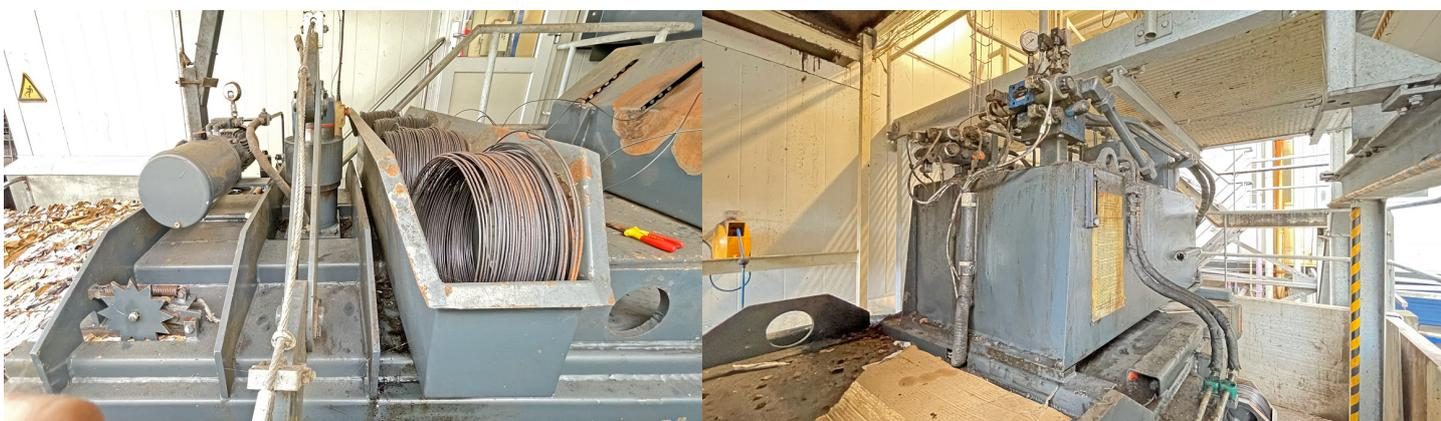
**Ballenpresse BRAMIDAN, Typ HC 50, 50 t Presskraft, Baujahr 2007, nur 11.970 Betriebsstunden, Antrieb 15 kW, mit 4-fach Vertikalabbindung**
