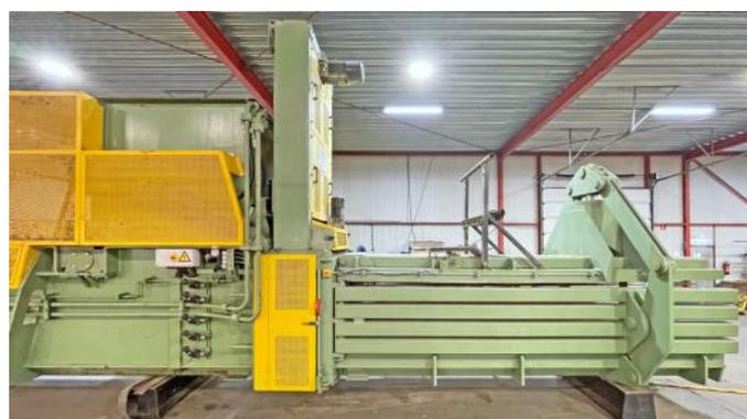
**Ballenpresse Bollegraaf, Typ HBC 110 K / 75 kW, überholt, 100 t Presskraft, Baujahr 2007, nur 22.605 Betriebsstunden, Antrieb 75 kW, mit 10-fach Kreuzabbindung**
