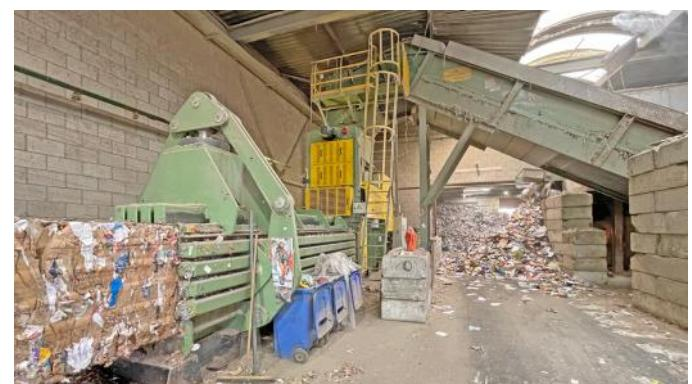
**Ballenpresse Bollegraaf, Typ HBC 140, 140 t Presskraft, Baujahr 2017, nur 19.187 Betriebsstunden, Antrieb 2 x 75 kW, inkl. Kettengurtförderband und Drahtzugstationen**
