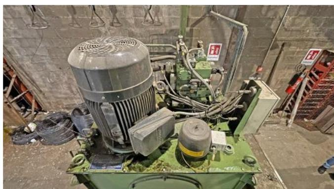
**Ballenpresse Bollegraaf, Typ HBC 60 A, 60 t Presskraft, Baujahr 2000, 32.169 Betriebsstunden, Antrieb 45 kW, mit Förderband und Drahtstationen**
