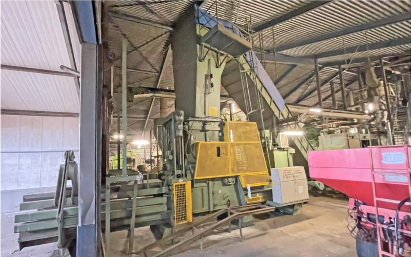
**Zum Verkauf steht eine komplette Pressanlage, bestehend aus einem Förderband mit Einwurftrichter, der Ballenpresse mit Ballenrutsche und Drahtzugstationen, ohne Draht.**
