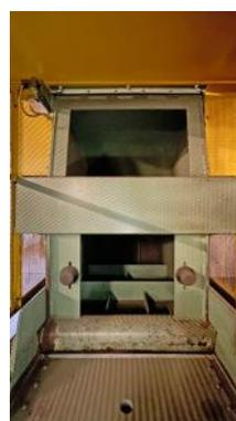
**Ballenpresse Bollegraaf, Typ HBC 80 AF, 78 t Presskraft, Baujahr 1994, 51.551 Betriebsstunden, Antrieb 45 kW, mit Förderband und Drahtstationen**
