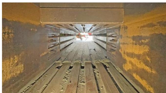
**Ballenpresse Bollegraaf, Typ HBC 80 AF, 78 t Presskraft, Baujahr 1994, 51.551 Betriebsstunden, Antrieb 45 kW, mit Förderband und Drahtstationen**
