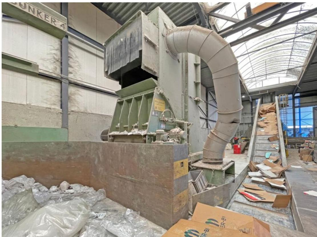
Der Shredder wurde zur Zerkleinerung von Papier, Karton, Zeitungen, Magazinen, Büchern etc. eingesetzt, um in der nachgeschalteten Ballenpresse eine optimale Verdichtung und Formstabilität der Ballen zu erreichen. Die Maschine ist in einem guten, betriebsbereiten Zustand und wird Ende April demontiert.
