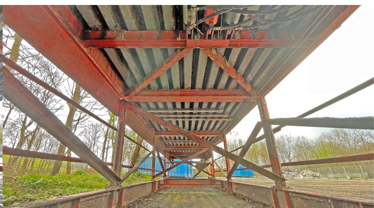
**Aufgabebunker mit hydraulischem Schubboden und Sackaufreißer, Hersteller BRT
