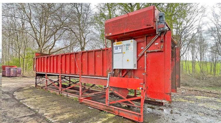
**Aufgabebunker mit hydraulischem Schubboden und Sackaufreißer, Hersteller BRT Hartner GmbH, Typ HP5-3035, Baujahr 2015, Bunkervolumen 30 m<sup>3</sup>**
