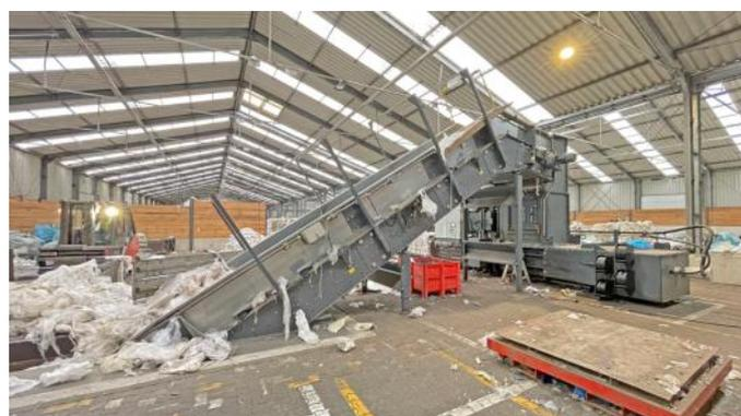
**Ballenpresse HSM, Typ VK 4812, 48 t Presskraft, Baujahr 2014, nur 5.059 Betriebsstunden, Antrieb 30 kW, mit 4-fach Horizontalabbindung**
