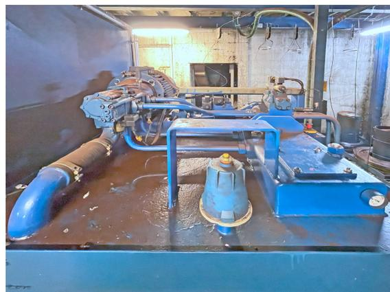
**Ballenpresse Presona, Typ LP 40 EH1, 40 t Presskraft, Baujahr 1995, 16.917 Betriebsstunden, Antrieb 18,5 kW, mit 5-fach Vertikalabbindung**
