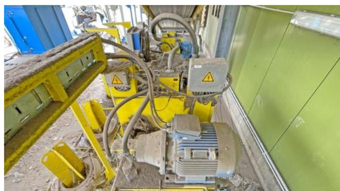
**Ballenpresse Riko Ekos, Typ S-60K (6), 60 t Presskraft, Baujahr 2019, nur 2.320 Betriebsstunden, Antriebsleistung 37 kW, mit 4-fach Horizontalabbindung**
