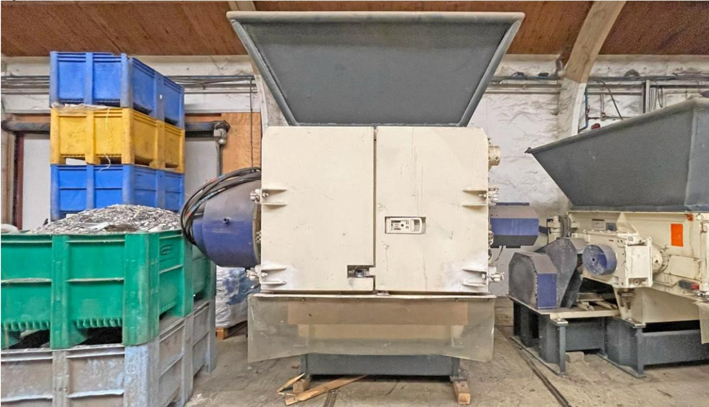
Der Rotationszerkleinerer VAZ 1300 M FF mit dem SureCut™ Cutting System ist speziell für die einstufige Zerkleinerung von Kunststofffolien und synthetischen Fasern konzipiert, die für die Extrusion zurückgewonnen werden. Die FF-Serie ist für einen hohen Durchsatz ausgelegt und verfügt über integrierte Messfunktionen und Temperaturüberwachungssteuerungen. Zu den Vorteilen des SureCut™ Schneidsystems gehören präzise Schnittlängen und hohe Schüttdichten.
