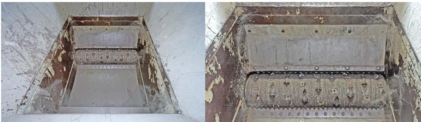
Einwellenzerkleinerer Vecoplan, Typ VAZ 1300 M FF T, Baujahr 2014,
